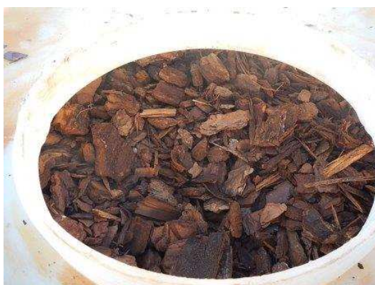
Differenti tipi di materiali alternati a riempimento del bio-filtro
